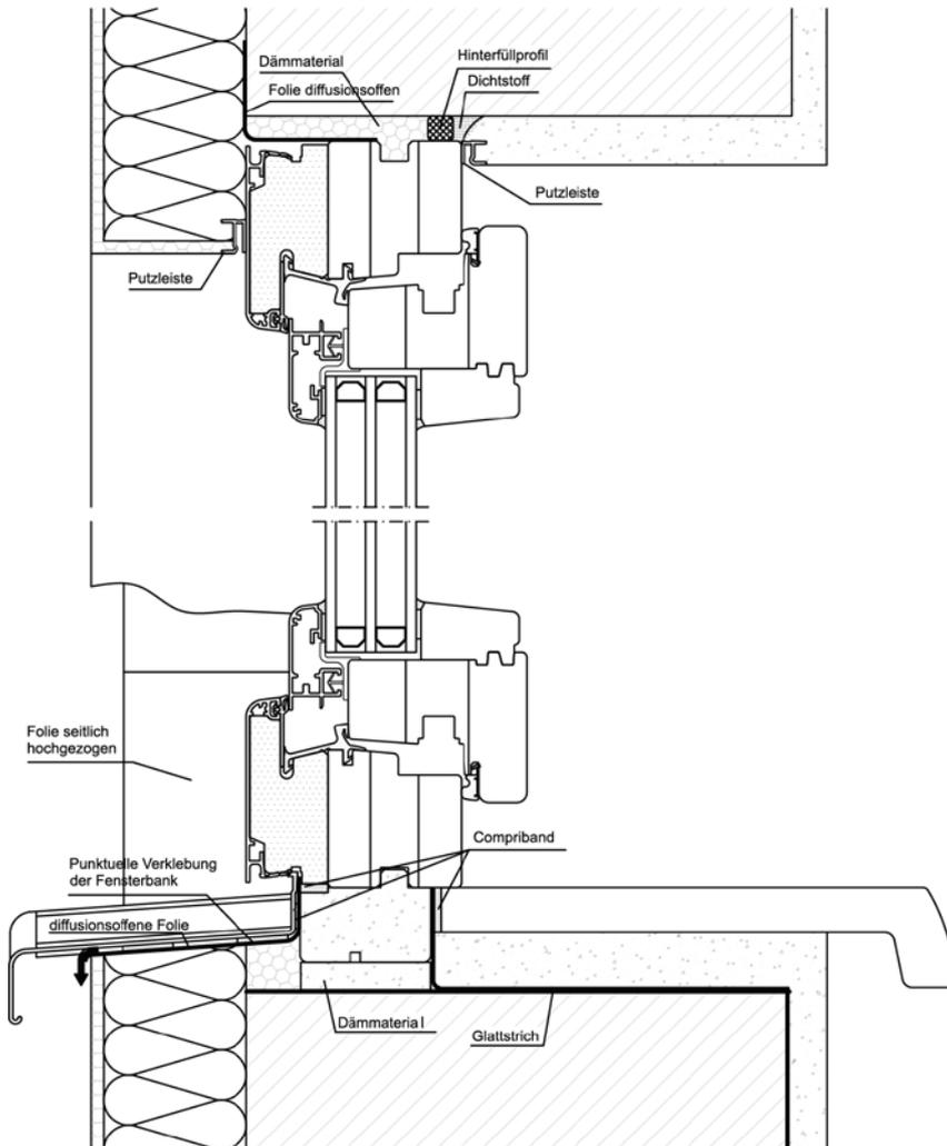
Bauanschluss mit Alu-Bodenschwelle 30mm.
